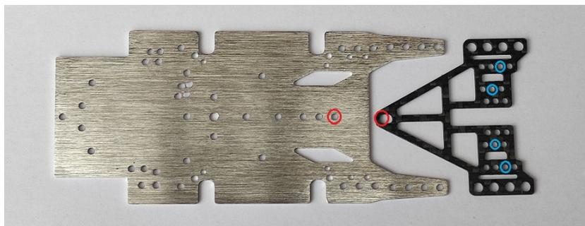
Legende: Rote Kreise: Position der hinteren T-Hülse. Position der vorderen T-Hülse freigestellt. Blaue Kreise: Verschraubungspunkte der Achsböcke.
