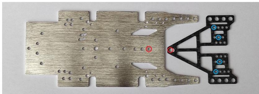
Legende: Rote Kreise: Position der hinteren T-Hülse. Position der vorderen T-Hülsen freigestellt. Blaue Kreise: Verschraubungspunkte der Achsböcke.
