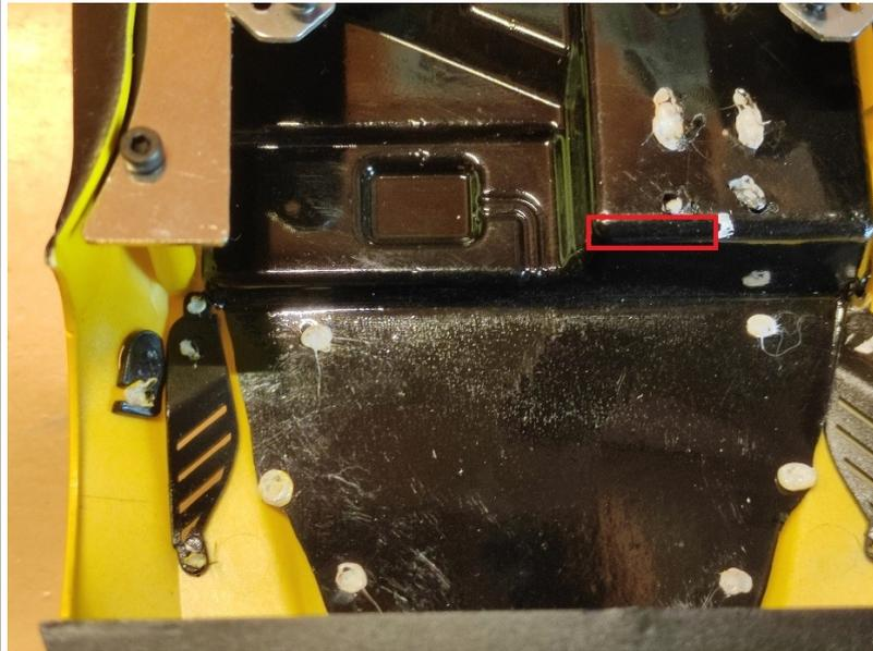
Die Problemzone wird mit einem „Pflaster“ (Abmessung 13 x 3mm) das aus einem weißen Aufkleber angefertigt wurde markiert.
