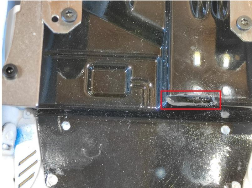
Abschließend wird die Rücklehne des Fahrersitzes durch das entstandene Loch mit Pattex „Extreme Repair“ Kleber zusätzlich mit dem Fahrerinslet verklebt.
