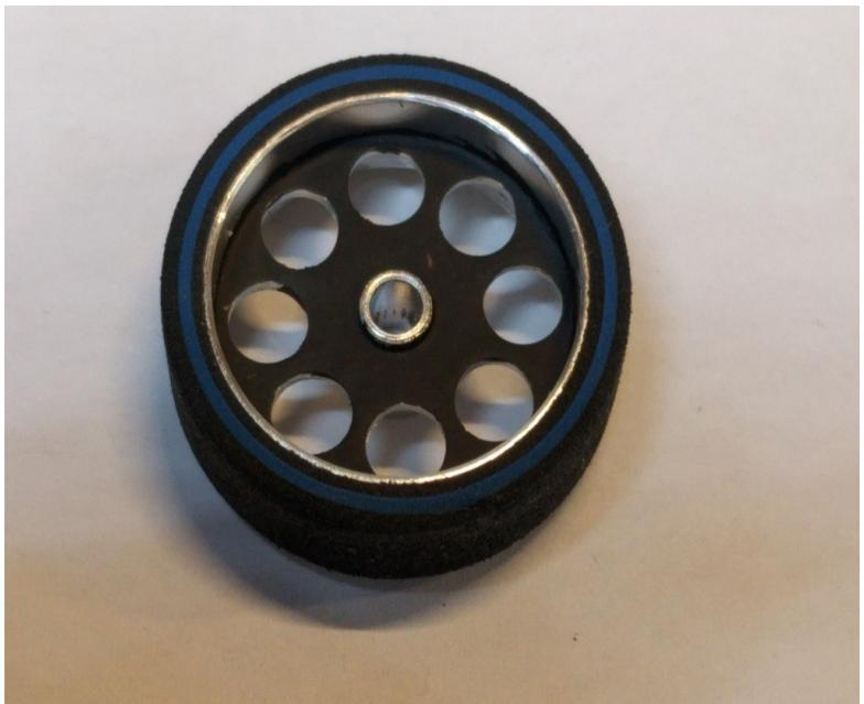
Als nächstes wird die Bremsscheibe mit dem Felgeneinsatz verklebt. Ich verwende dafür Sekundenkleber.
